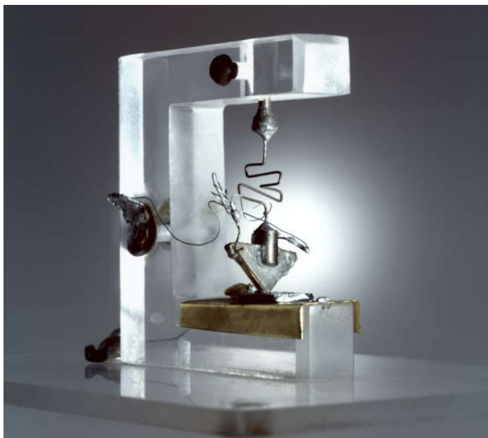
Izgled prvog germanijumskog tranzistora napravljenog 1947. god. u Belovim laboratorijama
