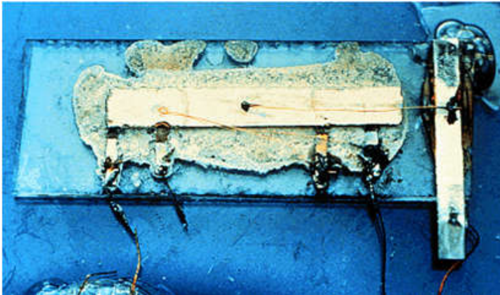
Izgled prvog integrisanog kola realizovanog po ideji Dž. Kilbija, 1958. god.
