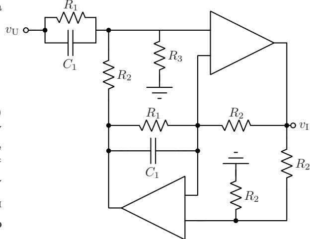
**5.** У колу са слике познато је  $C = 0,1 \mu\text{F}$ ,  $R_1 = 1 \text{ k}\Omega$ ,  $G_m = 2 \text{ mS}$ , и  $R_2 = 25 \text{ k}\Omega$ . Одредити (а) функцију преноса кола ако је улаз кола напон  $v_U$  а излаз кола напон  $v_I$ . Одредити и нацртати (б) одскочни одзив кола.
