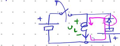
$$v_L = -V_A \Rightarrow \frac{di_L}{dt} = -0,1 \frac{\text{A}}{\mu\text{s}}$$
