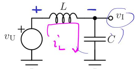
$$v_u = v_L + v_I \Rightarrow v_U = v_I + D^2 L C v_I$$
