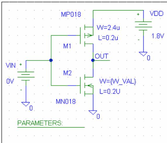
3. Na slici je prikazan jedan CMOS inverzor. Potrebno je, pomoću PSPICE-a, dobiti familiju prenosnih karakteristika ovog inverzora, gde je širina kanala tranzistora M2 parametar. Ovaj parametar treba da se menja od 0.8u do 1.4u sa korakom od 0.2u, a ulazni napon se menja u granicama napona napajanja, sa korakom od 1mV.
