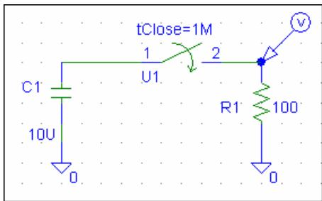
6. Kolo sa slike koristi se jednoj PSPICE simulaciji. Na slikama ispod ove dati su dijagrami dobijeni iz dve simulacije.
