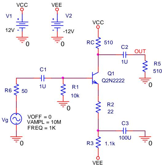
generiše pojačavač i ekvivalentnu vrednost šuma na ulazu pojačavača (INOISE) u opsegu učestanosti iz prethodne tačke. Naponi šuma na izlazu i ulazu pojačavača na učestanosti 1kHz su:  $V_{out} = \underline{\hspace{2cm}}$ ,  $V_{in} = \underline{\hspace{2cm}}$ .
