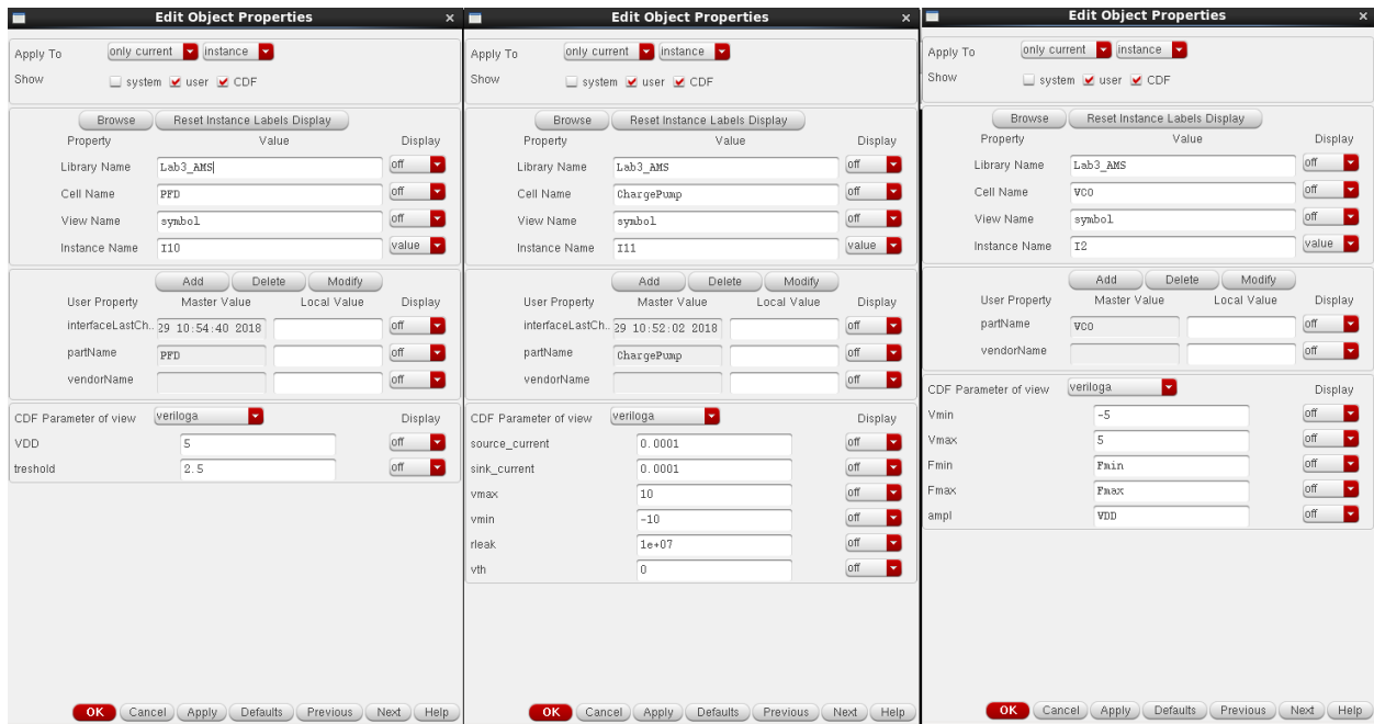
Слика 5.2. Подешавања фазно-фреквенцијског детектора, Charge Pump компоненте и напонско-контролисаног осцилатора.
