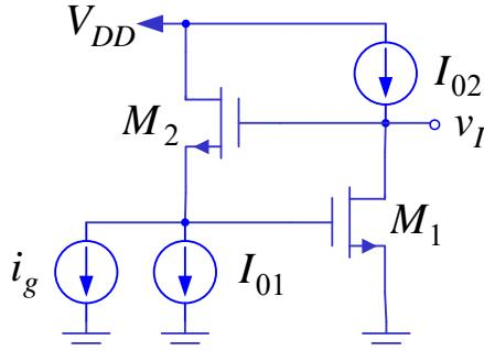
2. U kolu pojačavača sa slike upotrebljeni su tranzistori čiji su parametri  $\mu_n C_{ox} = 270 \mu\text{A/V}^2$ ,  $V_T = 0.45 \text{ V}$  i  $\lambda L = 0.08 \mu\text{m/V}$ . Dužine kanala oba tranzistora su iste  $L = 0.36 \mu\text{m}$ , dok je  $V_{DD} = 1.8 \text{ V}$  i  $I_{01} = I_{02} = 100 \mu\text{A}$ .
