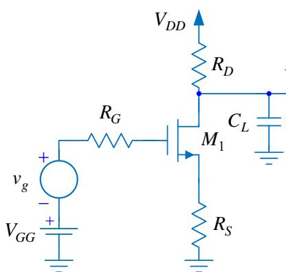
4. U pojačavaču sa slike upotrebljen je tranzistor čiji su parametri:  $\mu_n C_{ox} = 270 \mu\text{A/V}^2$ ,  $V_T = 0.45 \text{ V}$ ,  $\lambda \rightarrow 0$ ,  $C_{ox} = 8.5 \text{ fF}/\mu\text{m}^2$ ,  $C_{ov}/W = 0.35 \text{ fF}/\mu\text{m}$ ,  $C_{db}/W = C_{sb}/W = 0.50 \text{ fF}/\mu\text{m}$  i  $L = 0.18 \mu\text{m}$ , dok je  $V_{DD} = 1.8 \text{ V}$ ,  $R_G = 1 \text{ k}\Omega$  i  $C_L = 10 \text{ fF}$ . Zanemariti efekat osnove i Earlyjev efekat.
