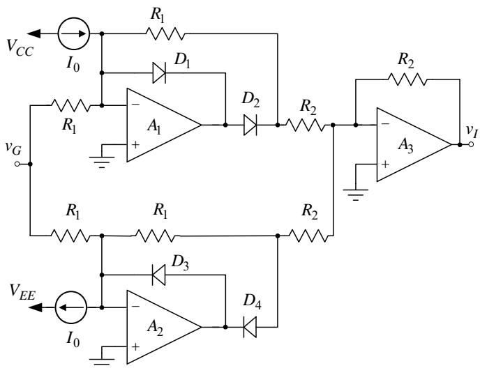
2. U kolu sa slike operacioni pojačavači se mogu smatrati idealnim i napajaju se iz baterija  $V_{CC} = 5\text{V}$  i  $V_{EE} = -5\text{V}$ , provodne diode imaju pad napona  $V_D = 0,6\text{V}$ , dok je:  $I_0 = 20\mu\text{A}$ ,  $R_1 = 50\text{k}\Omega$  i  $R_2 = 10\text{k}\Omega$ .
