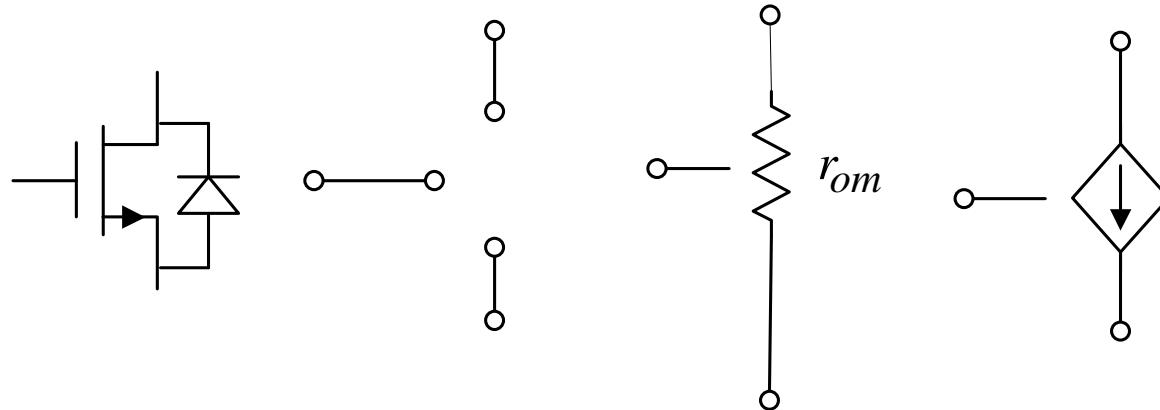
$$I_D = \begin{cases} \approx 0, & V_{GS} < V_T \\ \frac{B}{2} (V_{GS} - V_T)^2 (1 + \lambda V_{DS}) \approx \frac{B}{2} (V_{GS} - V_T)^2, & V_{GS} > V_T, V_{DS} \geq V_{GS} - V_T \\ \frac{B}{2} [2(V_{GS} - V_T)V_{DS} - V_{DS}^2], & V_{GS} > V_T, V_{DS} < V_{GS} - V_T \end{cases}$$
