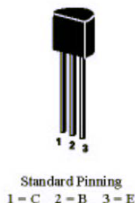
Slika 1 Raspored priključaka bipolarnog tranzistora BC337
